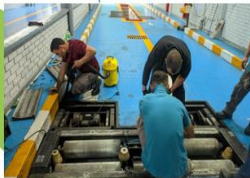
Probador de suspensión y taxímetro vehículos livianos y pesados
